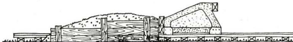
daß Wagen oder auch Lokomotiven auf die Prellböcke auffahren. Ein gut gebauter Prellbock soll das Arbeitsvermögen auflaufender Fahrzeuge gefahrlos abbremsen ohne das Fahrzeug, die Ladung oder den Prellbock selbst zu beschädigen.
