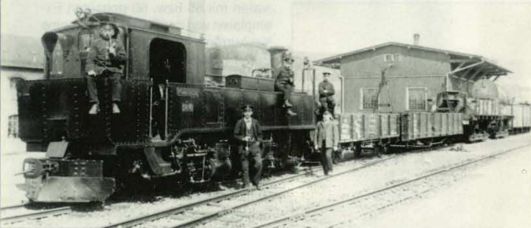
Bild 4: Eine IV K im Bahnhof Auerbach vor einem Schmalspurgüterzug. Der Lokomotivführer steht am Zylinder, der Heizer hat auf dem Kohlenkasten Platz genommen. Foto: Sammlung Scholz
