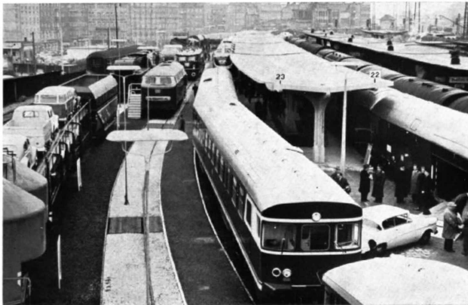
Abb. 7. Blick über einen Teil der Fahrzeugschau „Die moderne Bundesbahn“. Im Vordergrund der Maschinenwagen des dreiteiligen VT 23 (für den Nahverkehr), rechts der Doppelstock-Autotransportwagen DPw4ümg für den Fernverkehr (ein Auto fährt gerade auf die Hubbühne mit Schwenkdrehscheibe). Im Hintergrund (Mitte) die V 160, die E 41 und daneben der TEE-Maschinenwagen. Links einige moderne Spezialgüterwagen.
