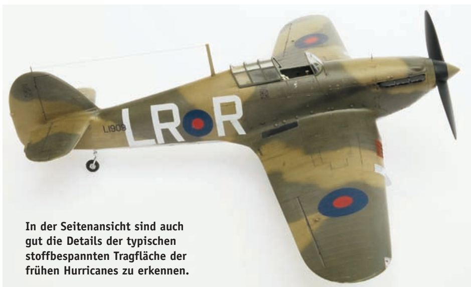
Der Zweiblattpropeller verleiht der Hurricane ein gänzlich anderes Erscheinungsbild. Man beachte auch das selbstgebaute Venturi-Rohr unter dem Cockpit.
