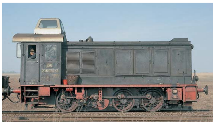
V 36 mit Dachkanzel: Starenkobel → 34
