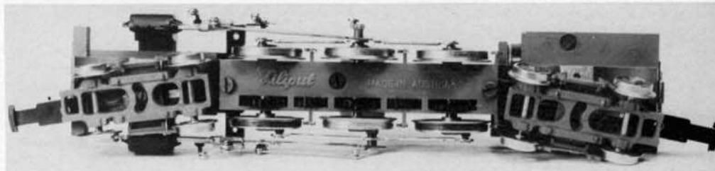
Bild 17: Das neue Fahrwerk der BR 78 von LILIPUT, die wir in dieser Ausgabe noch eingehender vorstellen.
