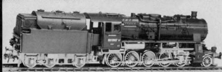
Bild 28: Eine BR 58 von ROCO nach dem Umbau in eine Kohlenstaublokomotive mit den fein geformten Umrüstsätzen von GÜNTHER. Foto: HJO
