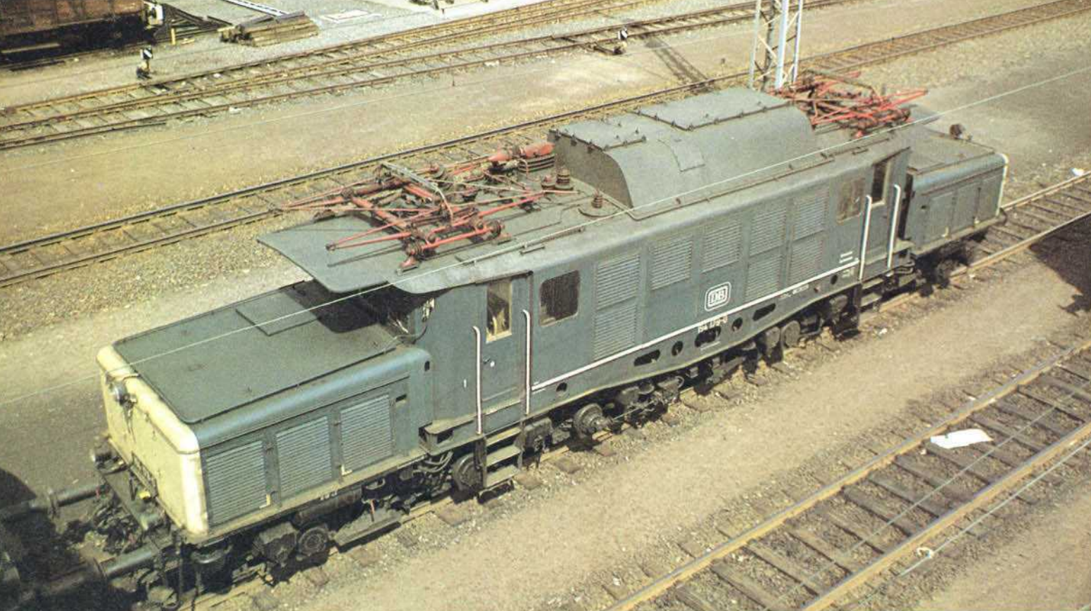
Bild 8: Beim Blick aufs Dach deutlich zu erkennen: die in den fünfziger Jahren aus Blendschutzgründen verlängerten Dachenden. Die 194 178 ist die einzige Vertreterin ihrer Baureihe, die einen ozeanblauen Anstrich erhalten hat. Darüberhinaus bemerkenswert sind auch die gummigefäbten Seitenfenster, die nur bei wenigen Lokomotiven der Baureihe 194 zum Einbau gelangten.
