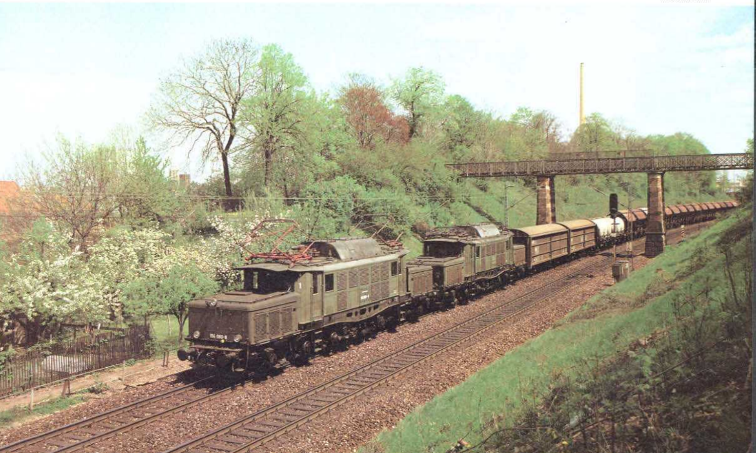
Bild 11: Im Winterfahrplan 1982/83 verkehrte an Sonntagen der Dg 61814 von München Ost nach Augsburg mit zwei Lokomotiven der Baureihe 194. Manchmal war die zweite Lokomotive aufgebügelt, oft aber wurde sie abgebügelt mitgeschleppt, wie auch am 1. Mai 1983. Die Aufnahme mit der 194 080 an der Zugspitze entstand zwischen München Ost und München Süd.
