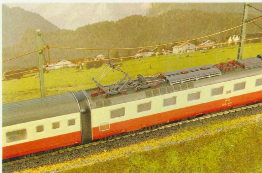
Bild 2. Blick auf die Dachpartie des Motorwagens; die Abdeckgitter sind durchbrochen und gesondert eingesetzt.
