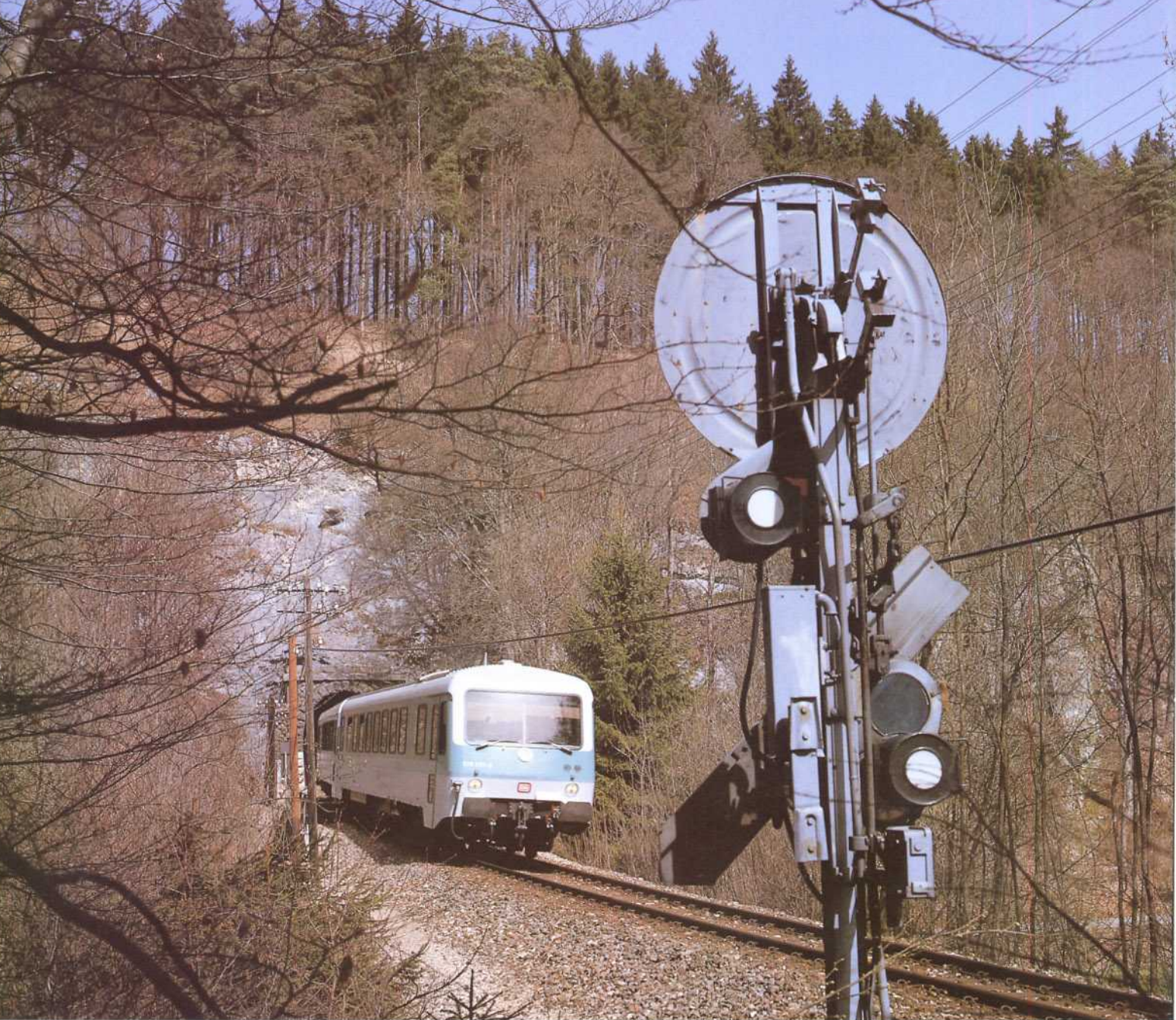
Bild 12: "Langsamfahrt erwarten" kündigt dieses Vorsignal bei Inzigkofen dem Triebfahrzeugführer des aus Tübingen kommenden 628 290 an (30. März 1989). Foto: A. Ritz
