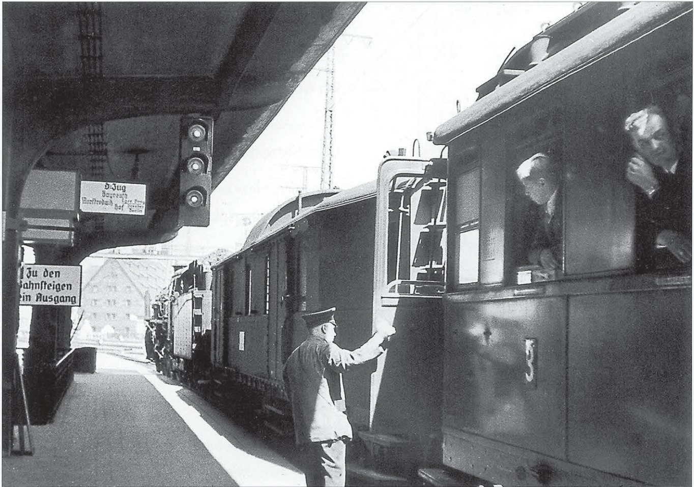
„Bremsen in Ordnung“ zeigt das Signal Zp 14 am 4.7.1935 in Nürnberg Hbf für D 179. Um 14.30 Uhr geht die Fahrt in Richtung Eger-Prag bzw. Dresden-Berlin.
