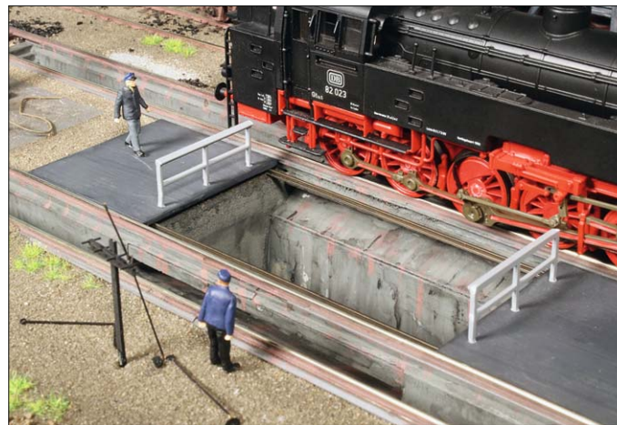
Treib- und Kuppelstangen sowie die Steuerung besaßen viele Lager. Hier kontrolliert der Lokführer die Lager direkt nach der Fahrt, um Heißläufer zu identifizieren. Die Ölgefäße der Stangenlager werden aufgefüllt.
