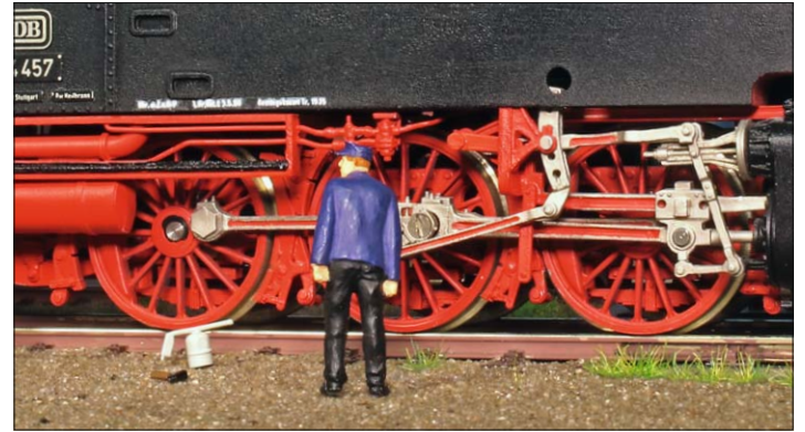
Treib- und Kuppelstangen sowie die Steuerung besaßen viele Lager. Hier kontrolliert der Lokführer die Lager direkt nach der Fahrt, um Heißläufer zu identifizieren. Die Ölgefäße der Stangenlager werden aufgefüllt.
