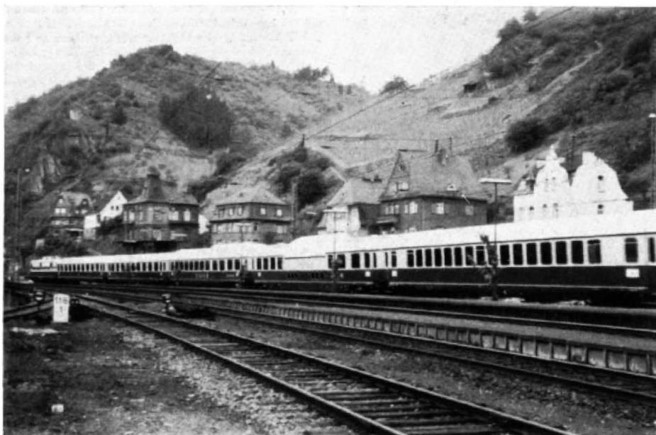
Abb. 1. Dieses Bild zeigt den gesamten „Rheingold“-Zug (mit Ausnahme des letzten Wagens) im Bf. Braubach bei der Ausfahrt in Richtung Lahnstein, anlässlich der Eröffnung der nunmehr durchgehend elektrifizierten rechten Rheinstrecke (womit jetzt rund 4500 km = 14,6 % des DB-Netzes elektrifiziert sind). Vorn die girlandengeschmückte E 10 1242, dahinter 2 Salon-(Abteil-)Wagen, der doppelstöckige Speisewagen, der Aussichtswagen und einer der Großraumwagen.
