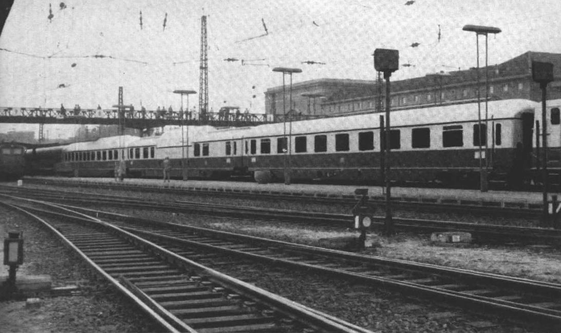
Abb. 4. Der „Rheingold“ in Mannheim Hbf. Ganz rechts außen spitzt eine E 10 hervor, es folgen: Abteilwagen I. Klasse, Aussichtswagen, Speisewagen mit zweigeschossiger Küche, Großraumwagen. — Abb. 5. Nochmals nah besehen: der Aussichtswagen mit verglaster Kuppel, die formmäßig stark an amerikanische Vorbilder angelehnt ist. (Fotos: R. Kirchner, Heidelberg)
