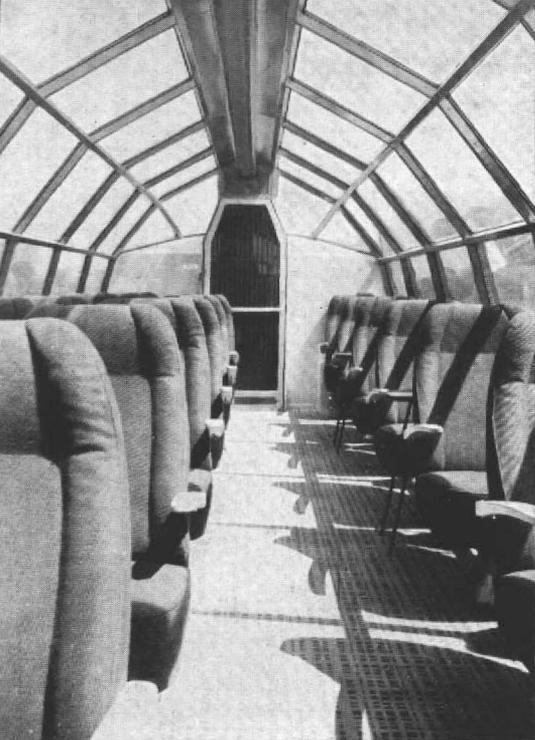
Abb. 2. Einzigartig ist der Blick aus der Aussichtskuppel. 22 Liegesessel, die in Fahrtrichtung gedreht werden können, laden zu einer beschaulichen Reise ein (besonders reizvoll bei der Fahrt durchs Rheintal), zumal auch dieser Wagen über eine Klimaanlage verfügt und die goldbedampften Scheiben das Sonnenlicht mildern. Wer Lust hat, kann von hier aus sogar telefonisch einen Reisebericht an die Angehörigen abgeben, und wenn er vom vielen Erzählen Durst bekommt . . .
