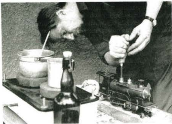
Bild 1 Etwas umständlicher als bei unseren heutigen elektrisch betriebenen Modelleisenbahnen geht es schon zu: Die Märklin (E 4021) wird mit Hilfe einer Klistierspritze gefüllt (Nenngröße I)
