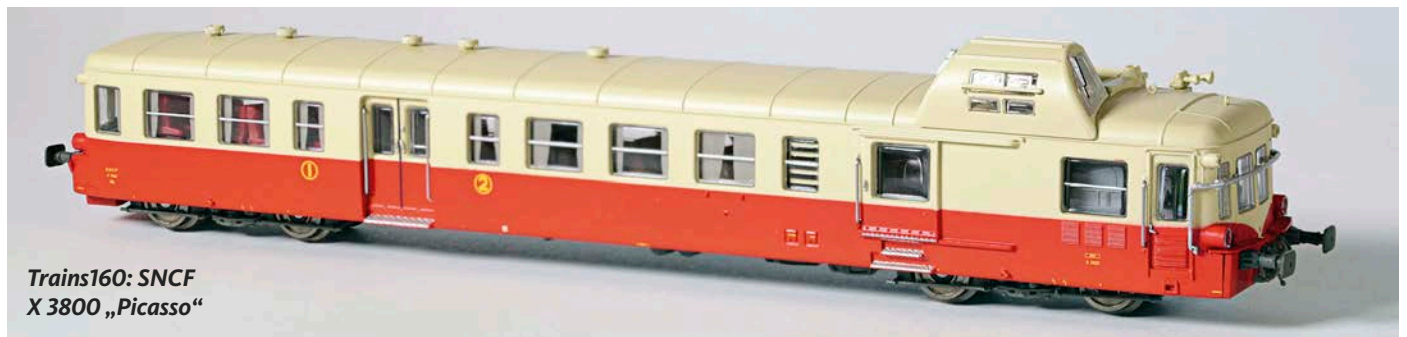
Trains160: Der seitlich hochgesetzte Führerstand ist nicht nur optisch ungewöhnlich, sondern auch in der Arbeitsplatzgestaltung
