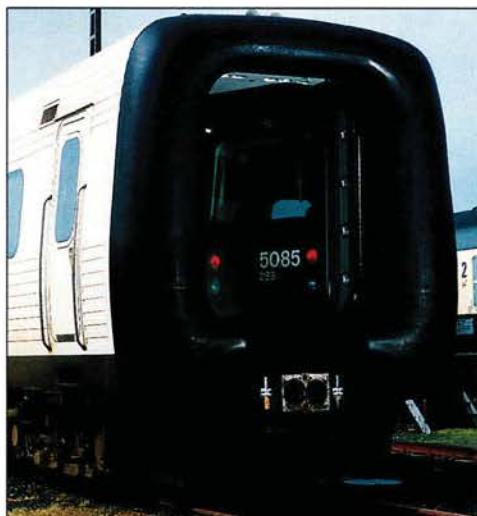
Der Führerstand des IC 3 ist binnen 45 Sekunden wegklapp- und verstau- und verschließbar. Danach ist der Wagenübergang im vollen Querschnitt offen.
