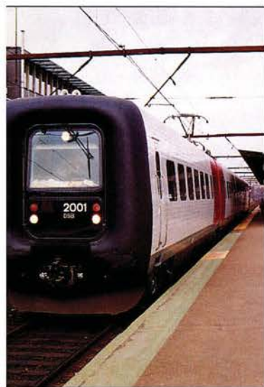
Die elektrische Version des IC 3 heißt IR 4E und ist mit dem dieselgetriebenen IC 3 kuppel- und gemeinsam steuerbar: Beim Betrieb unter Fahrleitung laufen die Dieselmotoren mit und beteiligen sich an der Traktionsleistung.
