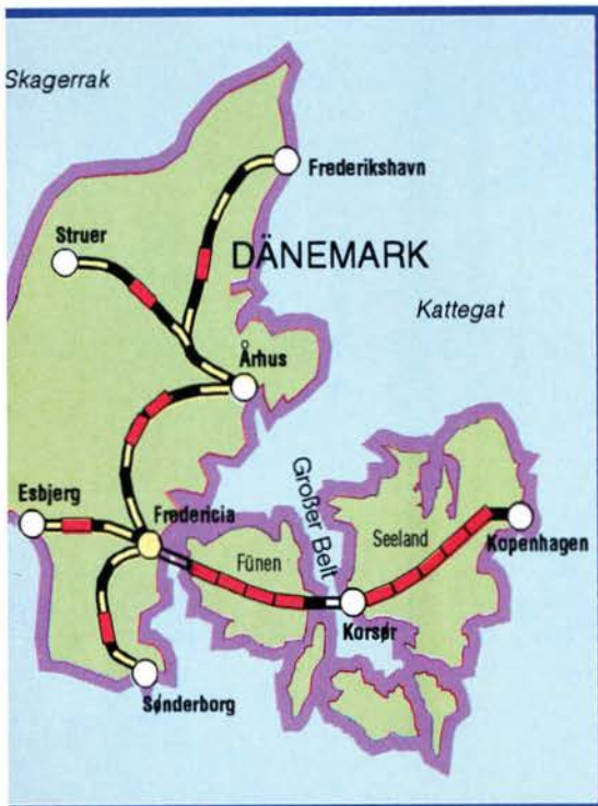
Das dänische System: Ein aus fünf Einheiten bestehender Zug verläßt København, wird am Großen Belt um eine Einheit geleichtert, trennt sich in Fredericia in drei und in Aarhus noch einmal in zwei Flügelzüge.
