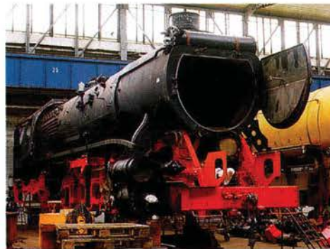
01 1102 am 1. September in Meiningen. Die ersten Träger für die Stromlinienverkleidung sind bereits angebracht.
