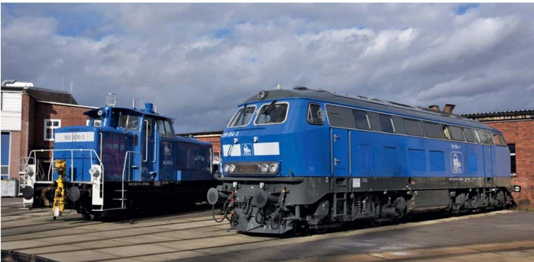
**DIE PRESS** erweitert ihre Diesellok-Flotte um eine 218 aus DB AG-Beständen: 218 448 wurde nach absolvierter Hauptuntersuchung im AW Cottbus noch im März an den neuen Eigentümer übergeben. Die Press reichte die 1977 gebaute Maschine als 218 054 in ihren Bestand ein. Das Bild zeigt die Lok am 11. März 2020 in Cottbus, 362 035 (362 915) war wegen nötiger Fristarbeiten zugegen.
