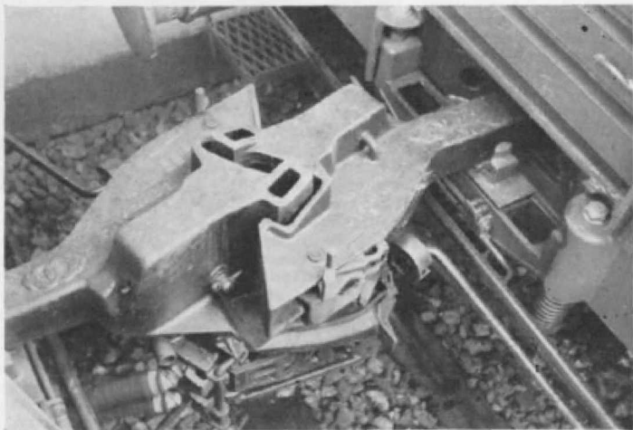
Abb. 6. Unicupler mit Hilfskupplung (Spezialschraubenkupplung) nebst Puffern, wie sie während der Umstellungszeit als Übergangslösung üblich sein wird.
