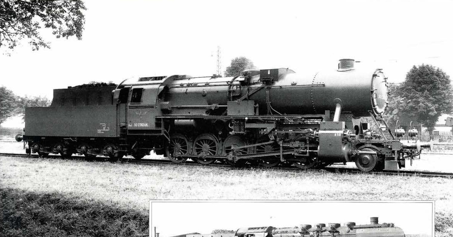
Bild 7: Die 50 2382 ÜK zeigt bereits starke Ähnlichkeit mit der Kriegslok der Baureihe 52. Sie wurde auch erst 1942 gebaut (Krauss-Maffei, F-Nr. 16257). Abb.: Slg. Weisbrod
