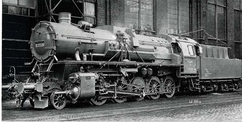
Bild 9: 50 2339, eine Henschel-Lieferung von 1942, zeigt den Weg zur Kriegslokom. Abb.: Werkfoto Henschel, Slg. Dr. Scheingraber
