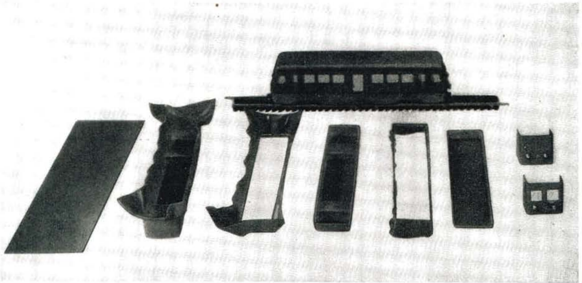
Bild 6 Im Vordergrund die verschiedenen gepreßten Teile, dahinter der fertige Triebwagen
