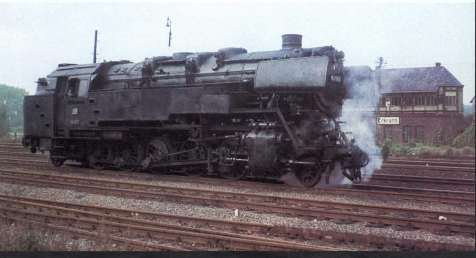
Bild 6: Nach Elektrifizierung der Strecke wurde die 85 007 auch auf der Steilrampe Erkrath-Hochdahl von Elektrolokomotiven verdrängt. Am 08.10.1960 war sie aber noch im Schubdienst in Erkrath eingesetzt. Foto: M. van Kampen
