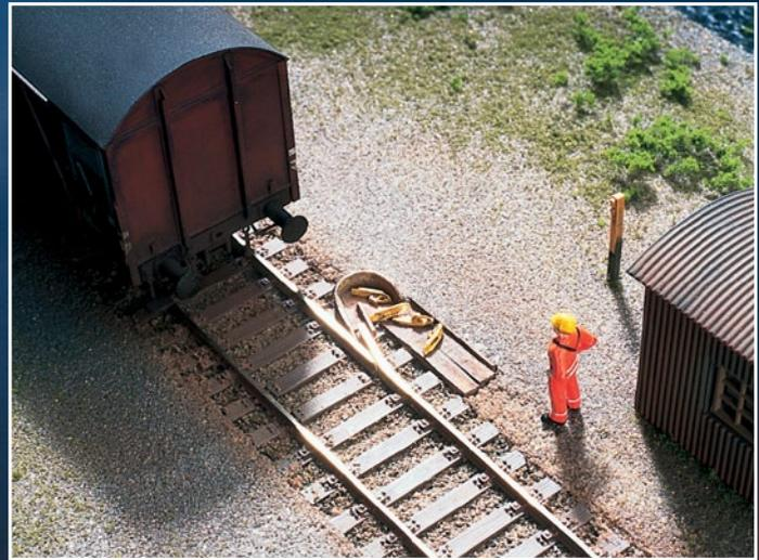
Hemmschuhe bremsen abgestoßene Wagen. Der Rangierer legt sie aufs Gleis, der rollende Wagen drückt sie in den Auswurfkasten.
