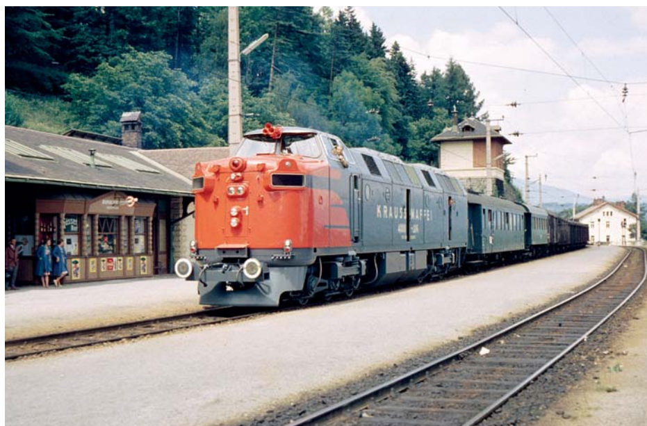
Bei den Probefahrten am Semmering und in Norddeutschland waren stets Messwagen in den Zügen eingereiht. Dort zeichneten analoge, elektromechanische Schreiber alle erforderlichen Daten auf.
