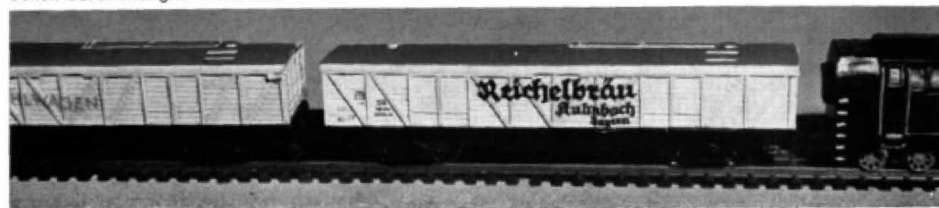
▼ Abb. 7. Der neue gedeckte Güterwagen ist eine Nachbildung des GG1hs 43, im Gehäuse bereits gut detailliert und in Braun bzw. Weiß mit verschiedenen Beschriftungen erhältlich.
