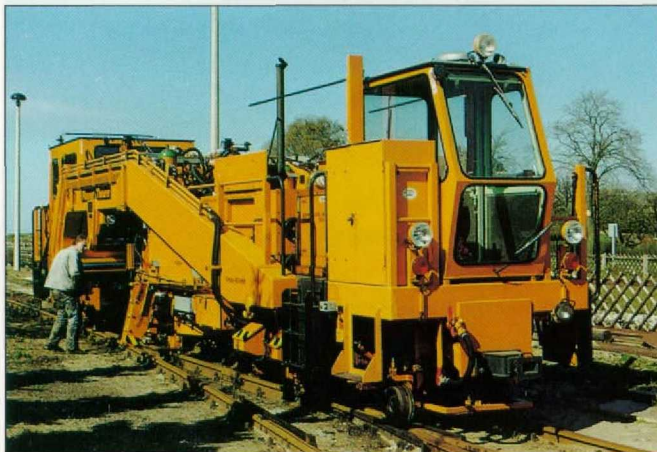
Bild 1. Stopfmaschine auf 900 mm-Spur im Arbeitseinsatz in Kühlungsborn West (10.4.90).
