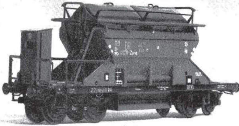
Bild 2 Modell eines Kkt-Wagens in der Baugröße H0, hergestellt vom Kollegen Dräger, Leipzig, nach eigenen Zeichnungen (Seite 104...107)
