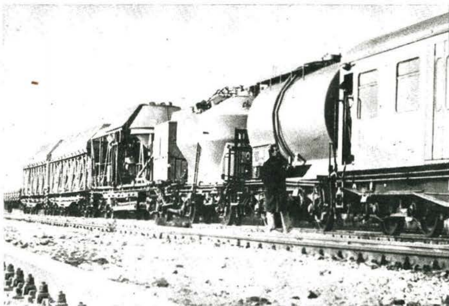
Betonmischzug 20/1 mit Aggregate-, Wasser-, Zementbehälter-, Mischer- und zwei Zuschlagstoff-Behälterwagen. Foto: Verfasser
