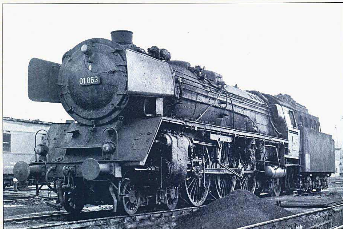
Bild 7: 01 063 mit Altbaukessel, Witte-Blechen und Pumpen in Fahrzeugmitte.
