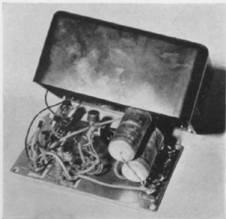
Abb. 2. Die Innereien des Effektivwertkonstanters (an vorhandenen Trafo anzuschließen).
