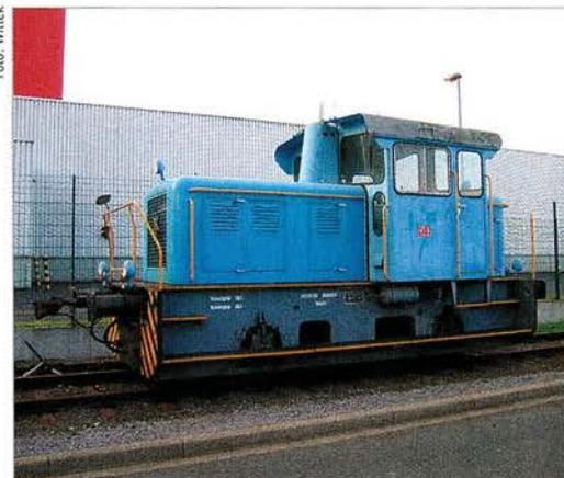
■ Dieser Henschel-B-Kuppler von „Vallourec & Mannesmann Tubes“ (V&M), Werk Düsseldorf-Reisholz, erhält derzeit eine neue HU, um dann als zweite Werkslokomotive für die Verschiebetätigkeiten auf dem Firmengelände zu dienen. Die Aufarbeitung erfolgt über Industriebahn Reisholz (IDR).
