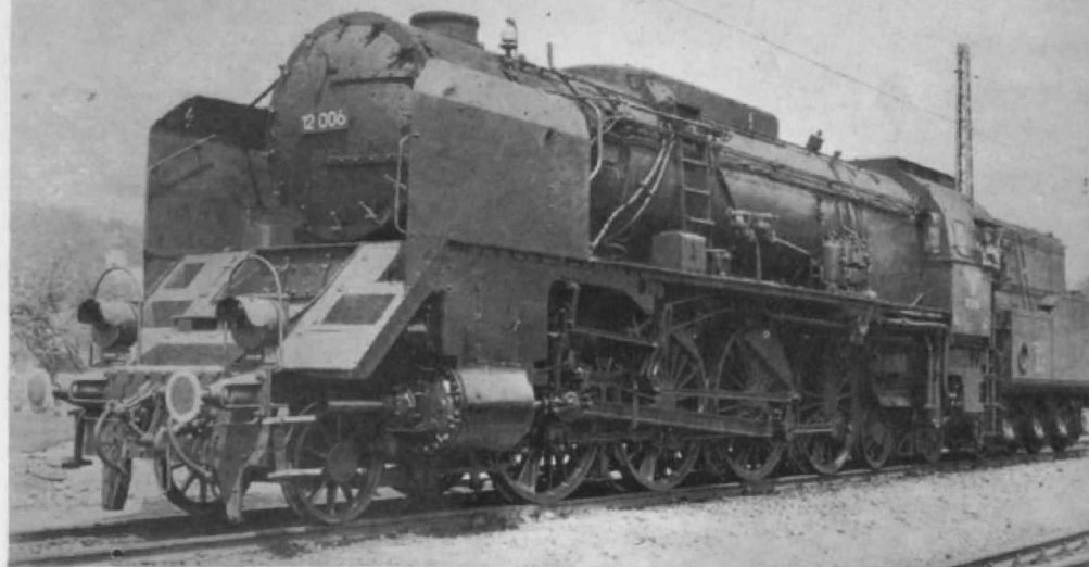
Abb. 1. Das Vorbild der heutigen Umbauanleitung: die mächtige österreichische Schnellzuglok der BR 12, mit der für deutsche Verhältnisse ungewohnten Achsfolge 1'D 2. (Foto: Lokbildarchiv Bellingrodt)
