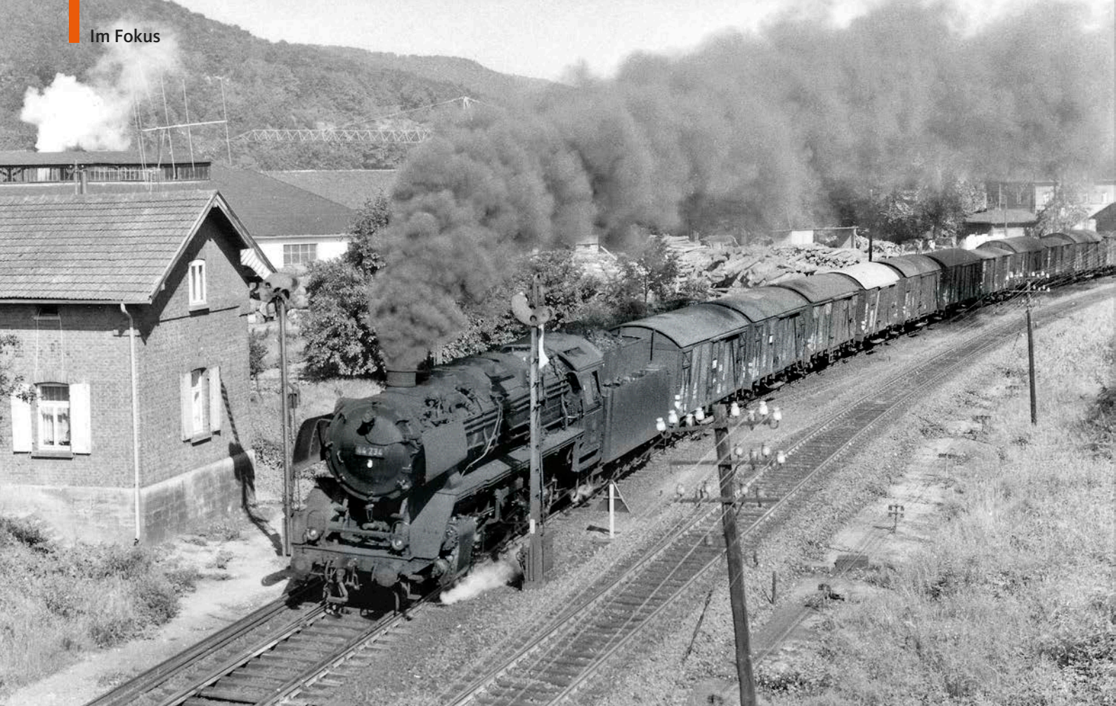
Die DB-Dampflok 44 234 verlässt mit ihrem hauptsächlich aus gedeckten UIC-St-2-Wagen gebildeten Durchgangsgüterzug im Juni 1966 vorbei an den bayerischen Ruhehalt-Signalen den Bahnhof Wernfeld an der Strecke Würzburg – Aschaffenburg. Gut zu erkennen sind die unterschiedlichen Wagendacheindeckungen
