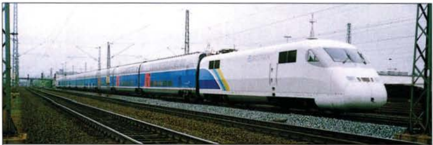
Der Euro-Train, ein Zug aus ICE-Triebköpfen und TGV-Mittelwagen, absolvierte am 27. April 1998 seine ersten Versuchsfahrten auf der Schnellfahrstrecke Göttingen – Hannover. Bei der offiziellen Präsentation am 4. Mai 1998 erreichte er eine Geschwindigkeit von 316 km/h. Der Euro-Train soll in Taiwan zum Einsatz kommen.
