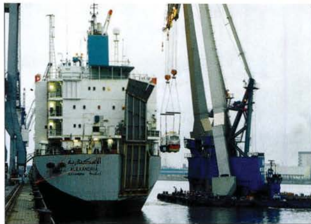
Schwindelfrei: Ein Schwimmkran verlädt eine rund 128 Tonnen schwere Expreßzuglok für Ägypten.
