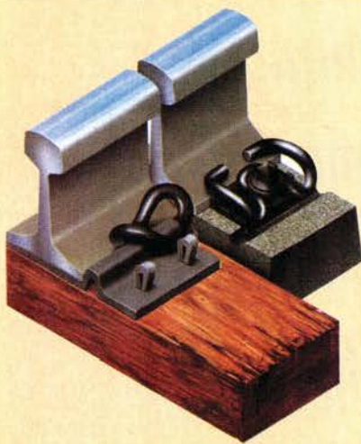
Befestigungen von Fahrstienen auf Holz- und Betonschwellen. Wichtig sind Festigkeit, Elastizität und einfache Montage.
