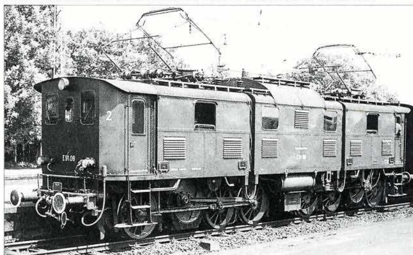
Bild 11: Ab Mitte der zwanziger Jahre dominierte der Schrägstangenantrieb Bauart Winterthur, wie hier bei der E 91. Abb. 8, 10 und 11: H. Obermayer
