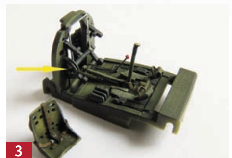
3 Ein Cockpitteil, das zu grob erschien, war der Hebel für die Sitzhöhenverstellung. Er wurde abgetrennt und mit Gussast ersetzt.
