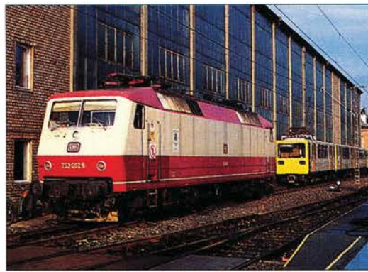
752 002 (ex 120 002) als Versuchsträger für Komponenten der künftigen Baureihe 121. Im Hintergrund ein Testzug für die Berliner U-Bahn mit Dachstromabnehmern.
