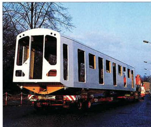
Wagenkasten für die Metro in Shanghai.
