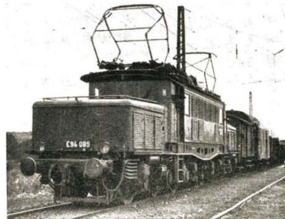
Bild 4 Die schwere Güterzuglok E 94 ist besonders für schwierige Gebirgsstrecken geeignet und soll später auf der Strecke Zwickau-Karl-Marx-Stadt-Dresden eingesetzt werden.
