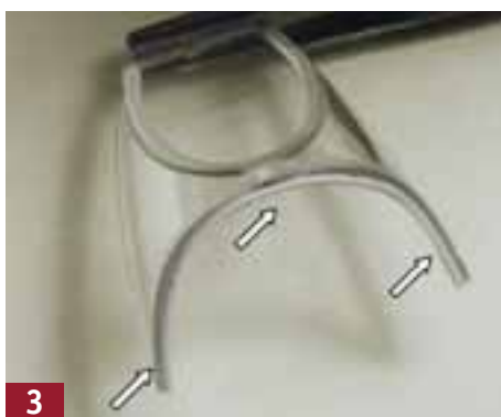
3 An der Frontscheibe wurde mit einem Sheetstreifen die Dichtung nachempfunden.
