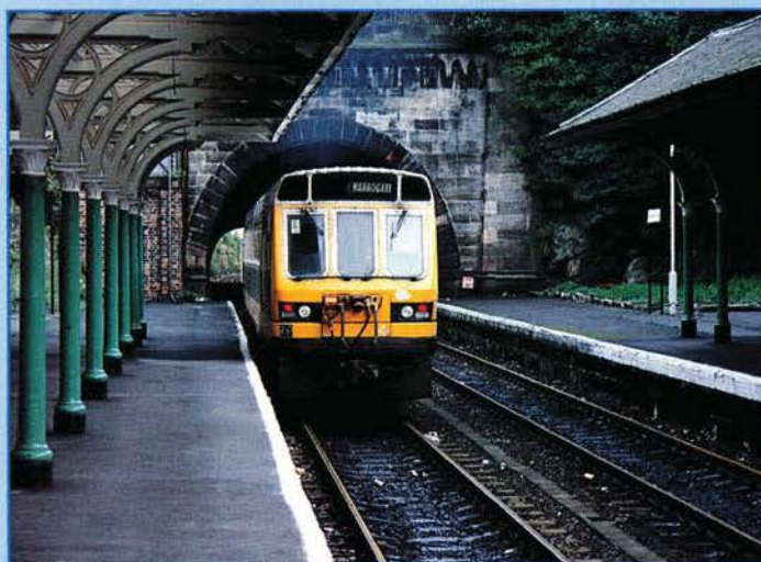
Historie: Einer der ersten Pacer-Schienenbusse, Leyland National-Buskarosserien auf Zweiachs-Fahrwerken (Knaresborough, North Yorkshire).
