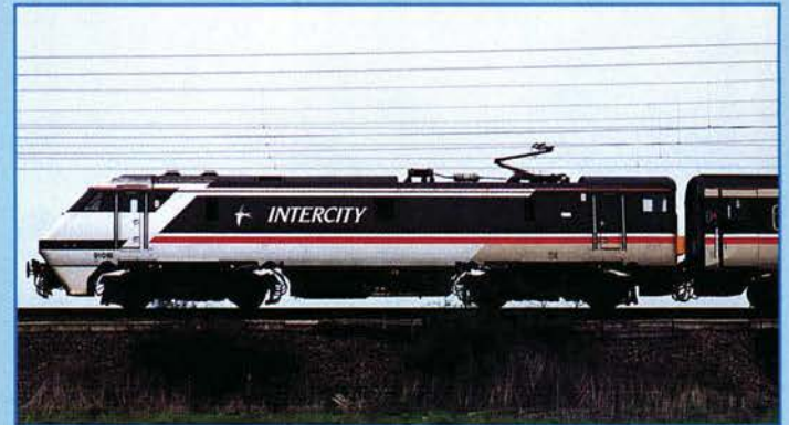
Moderne Zeiten auf der East Coast Main Line: Eine Class 91 schiebt ihren auf 200 km/h begrenzten IC 225 nördlich von York südwärts.
