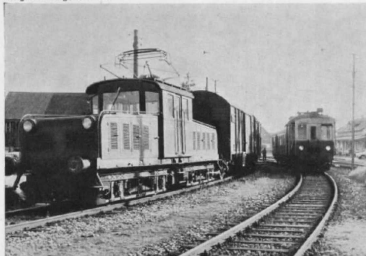
Abb. 6. Links eine Bo'Bo'-Ellok mit Druckluftbremse für den Güterzugdienst, daneben ein Gepäck-Triebwagen; beide Fahrzeuge wurden im Bahnhof Eferding beim Rangieren aufgenommen.
