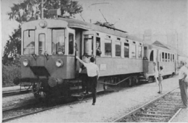
Abb. 5. Auch dieser 2-achsige Elektro-Triebwagen mit angehängtem B 41-Personenwagen gehört der Linzer Lokalbahn AG. Auf dem Dach sitzt nur ein Pantograph.
