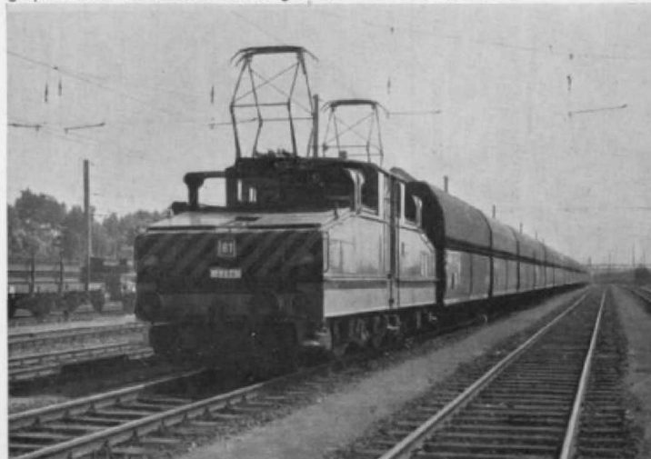
Abb. 7. Die Lok EH 81 der Betriebe „Eisenbahn und Häfen“ in Duisburg vor einem Ganzzug aus 4-achsigen Selbstentladern. Die Pantographen sitzen auf besonderen Trägern über den Motorvorbauten.
