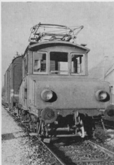
▼ Abb. 3. Die E 22002 der Linzer Lokalbahn AG in der Frontansicht. Interessant ist das mittlere Stirnfenster, das offensichtlich heruntergelassen werden kann.
