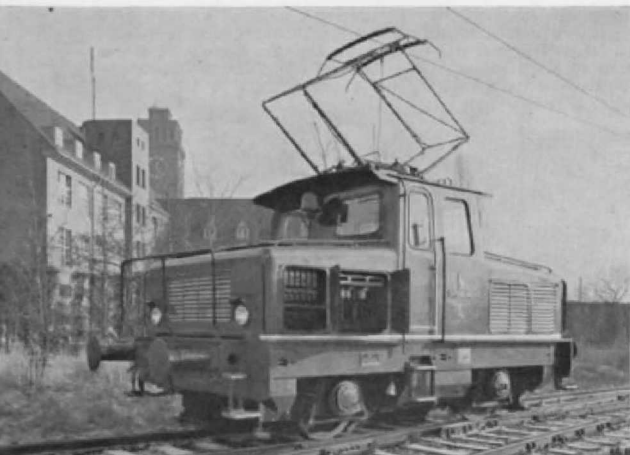
Abb. 1. Auf der Siemens-Güterbahn in Berlin verkehrt diese 600 V-Ellok (Achsfolge Bo) mit 2 Motoren à 230 kW. Man beachte die große Glocke zwischen den beiden Frontfenstern!
