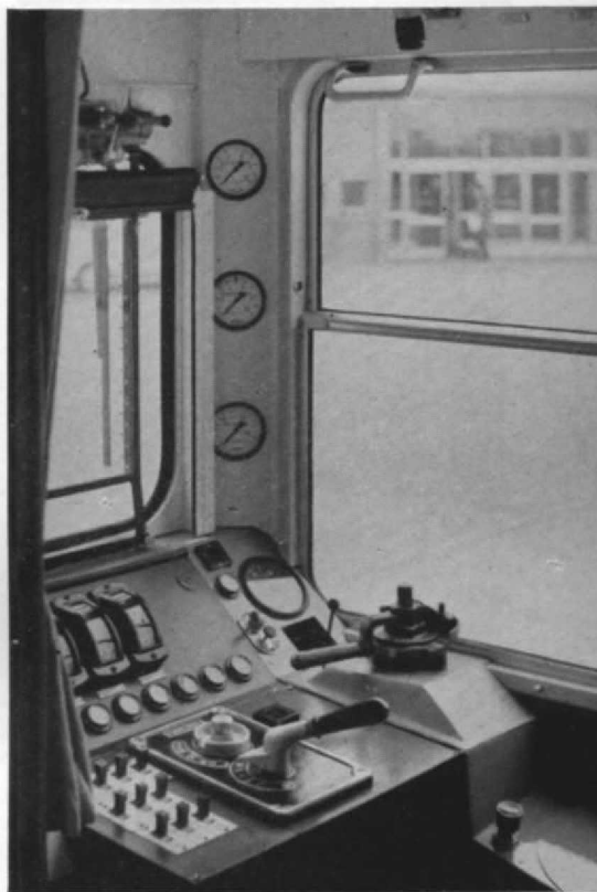
Abb. 3. Blick in das Führerstands-Abteil eines Wendezugsteuerwagens neuerer Bauart (BD4nf, also ein 2.-Klassewagen mit Dienstabteil, übrige Beschriftung wie Abb. 1). (Foto: H. Kriskker, Berlin)
