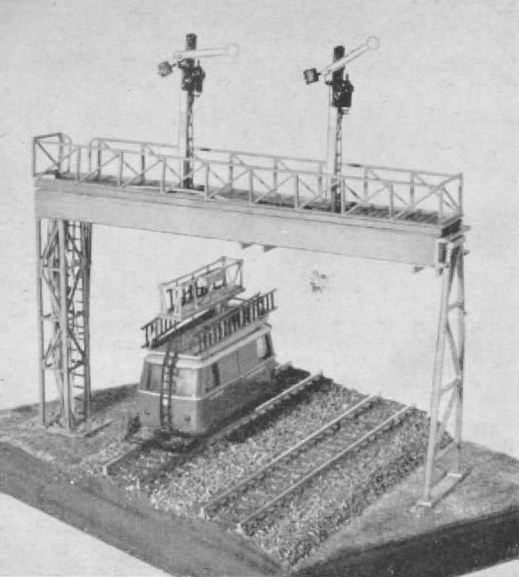
H0 Abb. 20. Die Formsignal-Brücke, deren Signale sich innerhalb des Stegs verschieben lassen; darunter der verbesserte Oberleitungs-Arbeitswagen.
