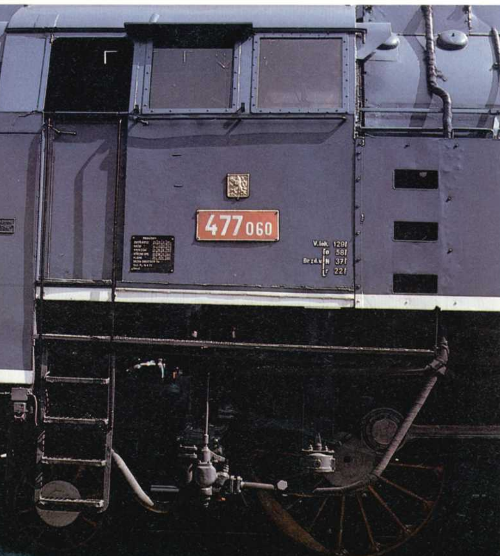
Bild 5: Die schwerste Dampflokomotive der ČSD, die Reihe 477.0, genannt der PAPAGEI. Erbauer war ČKD in Prag.
