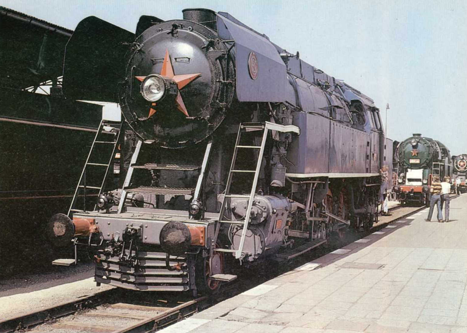
Bild 5: Die schwerste Dampflokomotive der ČSD, die Reihe 477.0, genannt der PAPAGEI. Erbauer war ČKD in Prag.
