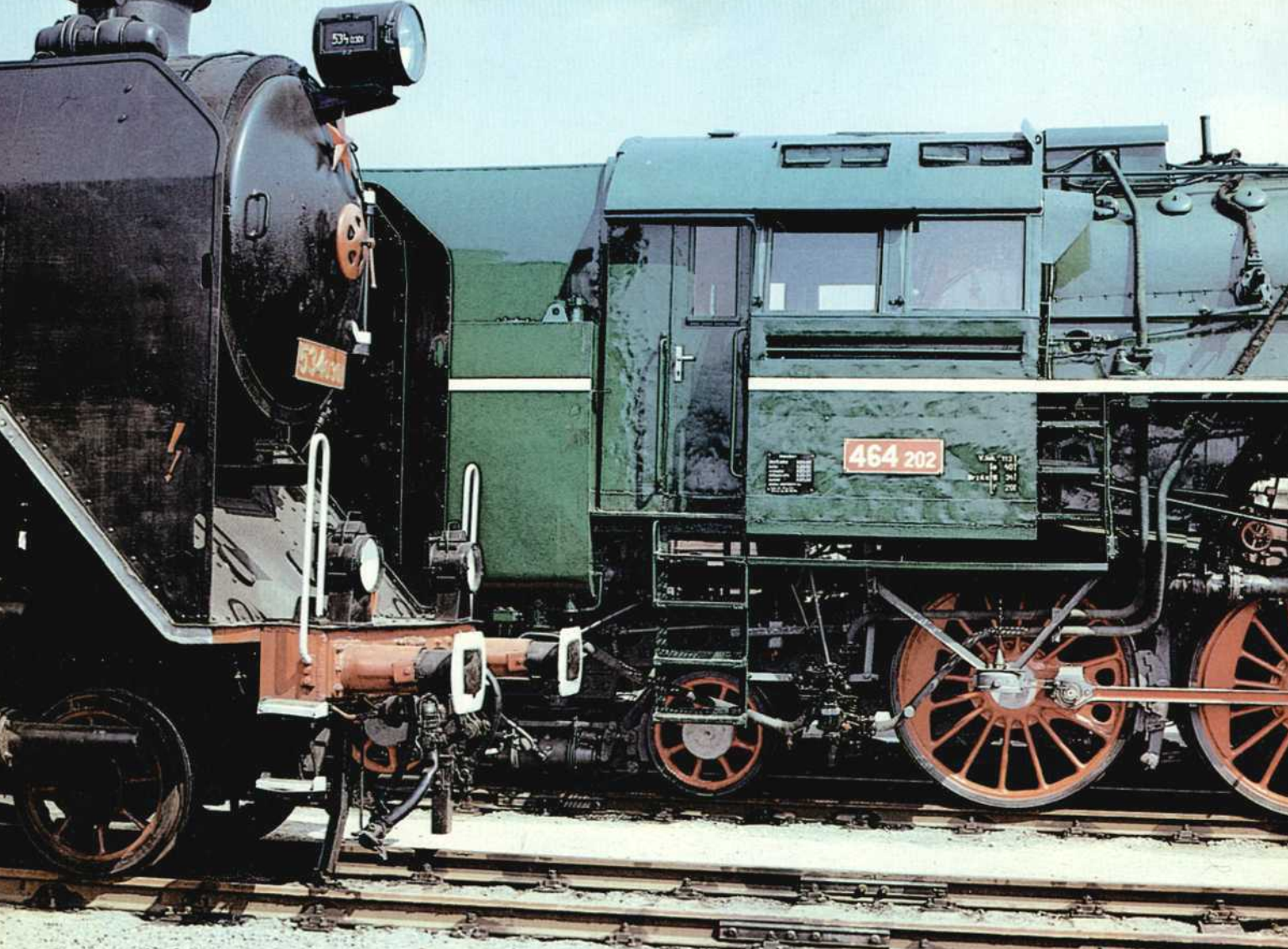
Bild 1: Zwei Generationen tschechoslowakischer Lokomotiven. Die Einheitslokomotive 534.0 aus der Epoche 1925— 1945 und die Neubaulokomotive 464.202, die letzte Entwicklung der ČSD. Foto: M. Weisbrod
