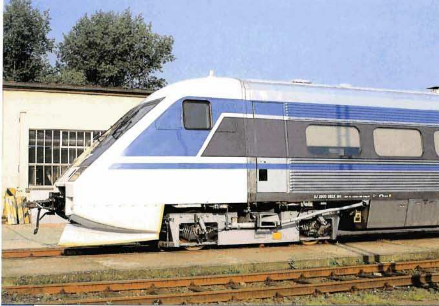
Bild 8: Drehgestell am Steuerwagen eines X 2 resp. X 2000 der SJ. Abb.: J. Hörstel
