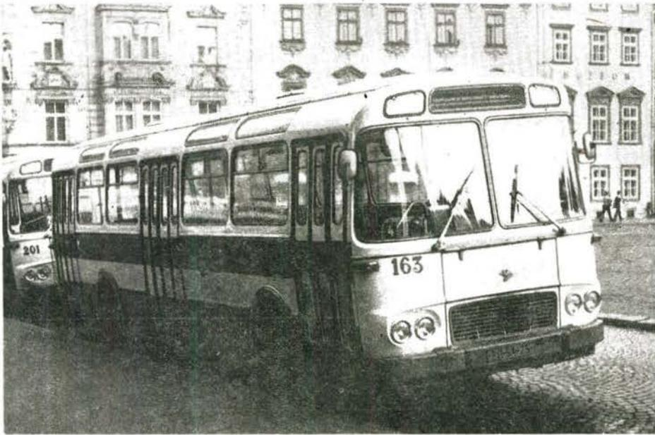
Bild 8 In Plzeň gehört der mit einem Motor von 110 kW Leistung ausgestattete Obustyp Skoda 9 Tr seit mehr als eineinhalb Jahrzehnten zum Stadtbild. Heute verkehren auf den Obuslinien fast ausnahmslos diese bewährten Fahrzeuge. Der Wagen Nr. 163, aufgenommen an der Haltestelle „Městské lázně (Städtische Badeanstalt)“, ist Baujahr 1967.
