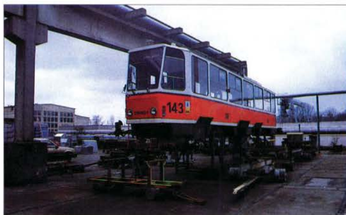
Die ersten BVG-Fahrzeuge sind bereits in Mittenwalde. Der Wagen 218 143-1, ein T6, wird zerlegt und danach völlig neu aufgebaut.
