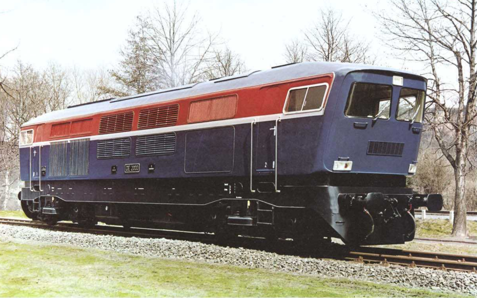
Bild 1: Die DE 2000, im Jahre 1962 von Henschel und SSW gebaut, war die erste rein deutsche dieselelektrische Streckenlokomotive mit 2000 PS Leistung. Werkfoto Henschel, Archiv Ritz
