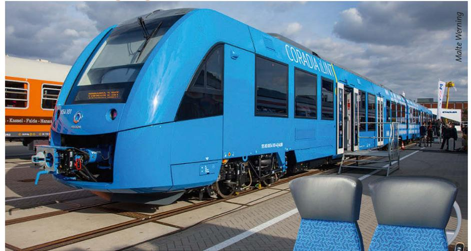
*Ein echtes Highlight der diesjährigen InnoTrans war der iLINT genannte Brennstoffzellen-Triebzug, den Alstom im Außenbereich präsentierte. Das Fahrzeug, das ab 2018 bei der EVB in Niedersachsen zum Einsatz kommen wird, soll mit Wasserstoffantrieben werden – ein Sachverhalt, auf den der Hersteller sogar im Muster der Sitzbezüge aufmerksam macht*
