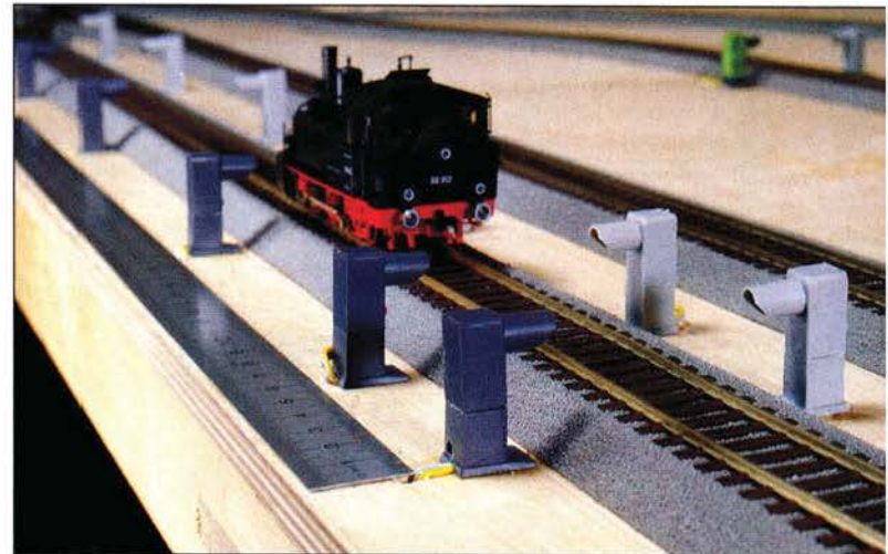
Lichtschranken schalten die computerinternen Stoppuhren zum Beispiel für die Geschwindigkeitsmessung.
